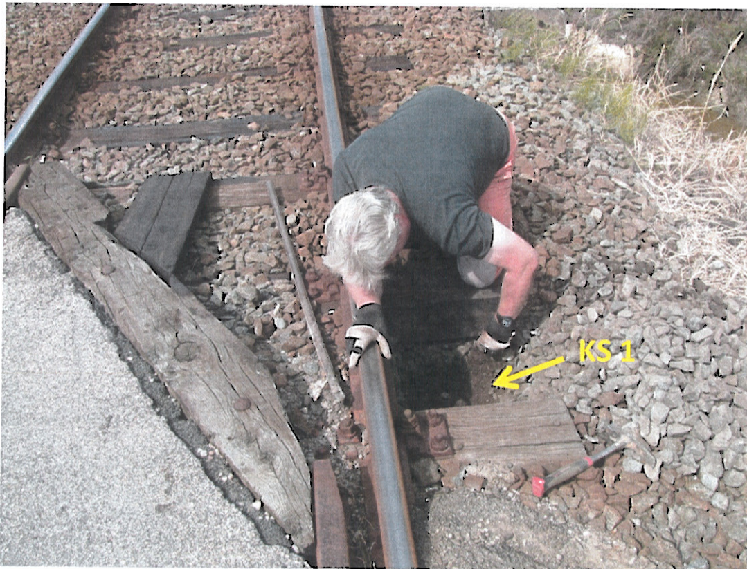
Místo realizace kombinované sondy (kopaná část/zarážená sonda)
